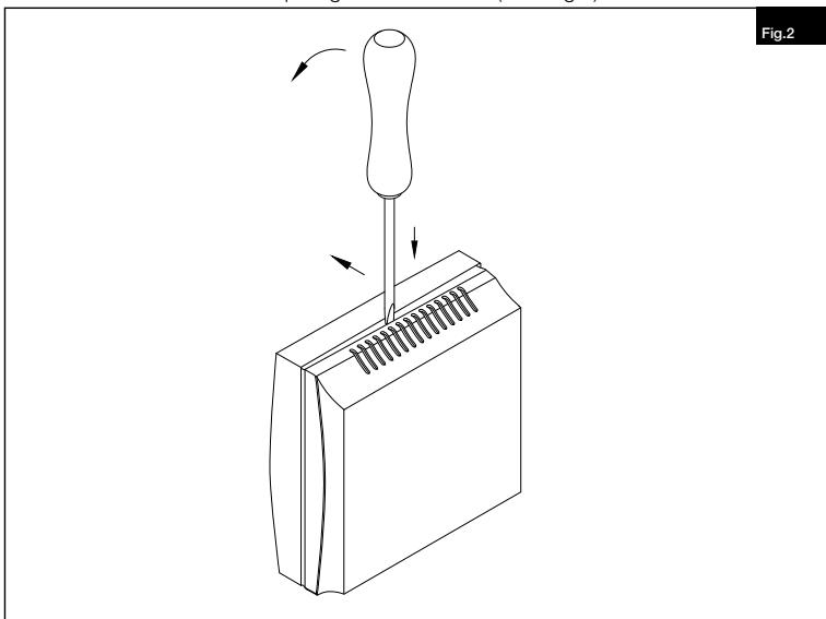
Pour le remontage ultérieur, accrocher les crochets d'encliquetage sur un côté de la partie inférieure du boîtier et enclencher le boîtier.
