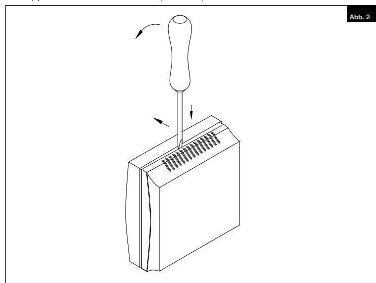
Beim späteren Zusammenbau die Schnapphaken auf einer Seite des Gehäuseunterteils einhaken und das Gehäuse einrasten.
